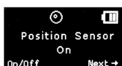
Appuyez à nouveau sur "Next" pour afficher le **Détecteur de Position**. Le Détecteur de Position peut être activé ("On") ou désactivé ("Off") en sélectionnant "On/Off". Le sensor se remet en position On automatiquement une fois l'IDAL® 3G Twin éteint.
