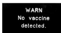
Lorsque les détecteurs à l'intérieur de l'appareil détectent du liquide de rinçage ou que le flacon est vide alors le message **"WARN No Vaccine detected"** s'affiche à l'écran.
