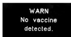
Lorsque les détecteurs à l'intérieur de l'appareil détectent du liquide de rinçage "**WARN No Vaccine detected**" s'affiche à l'écran.
