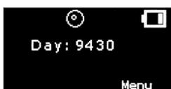
L'affichage initial indique l'état actuel du détecteur de position (On/Off), le compteur journalier ou / et de la séance et l'état de la batterie. Le défilement des options d'affichage "Menu", "Next", "Reset", se réalise grâce aux deux boutons sous le cadran d'affichage.
