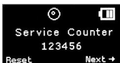
Appuyez sur "Next" à nouveau pour afficher le **compteur de maintenance**. Pour remettre à zéro le compteur de maintenance, appuyez sur "Reset" durant au moins 3 secondes.
