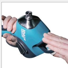
**NB :** si du liquide fuit à la base du dispositif, tenez simplement l'IDAL® 3G tête en bas lors de la mise en place du flacon dans le porte-flacon.
