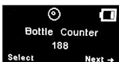
Appuyez sur "Next" pour afficher le **compteur par flacon**. Au dessous, le nombre d'injections réalisées avec le flacon s'affiche. Pour modifier les valeurs, appuyez sur "Select". La valeur à modifier commence à clignoter et peut être remise à zéro en appuyant sur "Reset" durant au moins 3 secondes.
