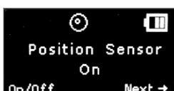
Appuyez à nouveau sur "Next" pour afficher le **Détecteur de Position**. Le Détecteur de Position peut être activé ("On") ou désactivé ("Off") en sélectionnant "On/Off". Le sensor se remet en position On automatiquement une fois l'IDAL éteint.
